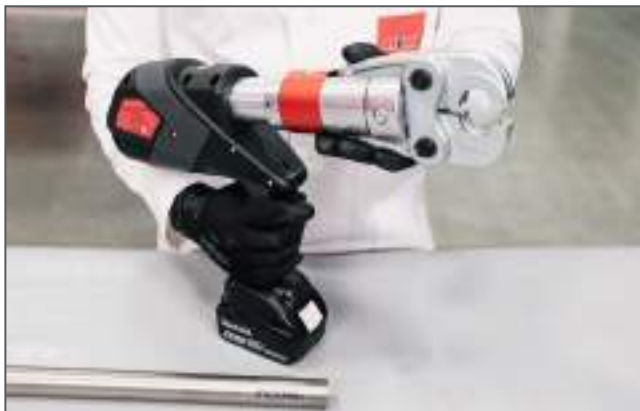
Preparazione della macchina pressatrice / Press machine preparation
